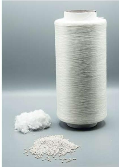
Faserabfall aus der Filamentfaserproduktion, das hochqualitative Regranulat, zu dem es recycelt wurde, und eine aus diesem Regranulat mit Filamenttechnologie ausgesponnene Faser mit 3 dtex
