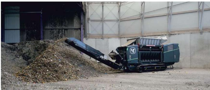
Der Equalizer ist als rein elektrisch angetriebene Maschine konzipiert
