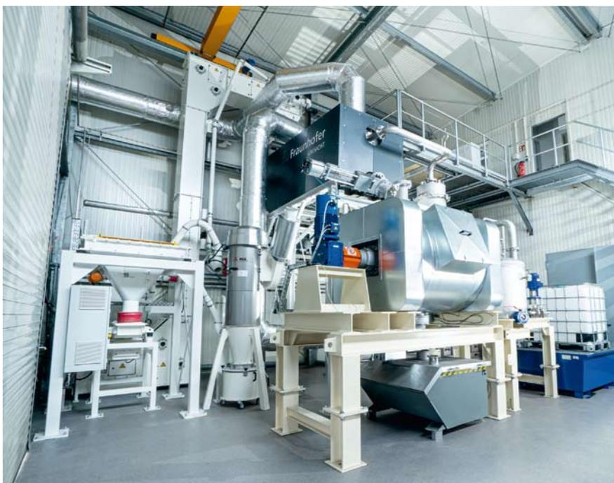
Demonstrationsanlage für die thermische Aufbereitung von teerhaltigem Straßenaufbruch bei Fraunhofer Umsicht in Sulzbach-Rosenberg
