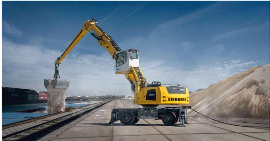
Elektro-Umschlagmaschine LH 40 M Port
