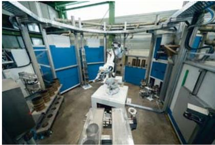
Möglichkeiten: Auch andere wertvolle Materialien wie Zwischenprodukte, die im Hüttennetzwerk anfallen, können künftig effizient und sicher beprobt werden. Schon heute ermöglicht die Anlage eine durchgängig mechanische Probenaufbereitung von Leiterplatten, eisenhaltigen geschredderten Fraktionen sowie getrockneten Schlämmen.
