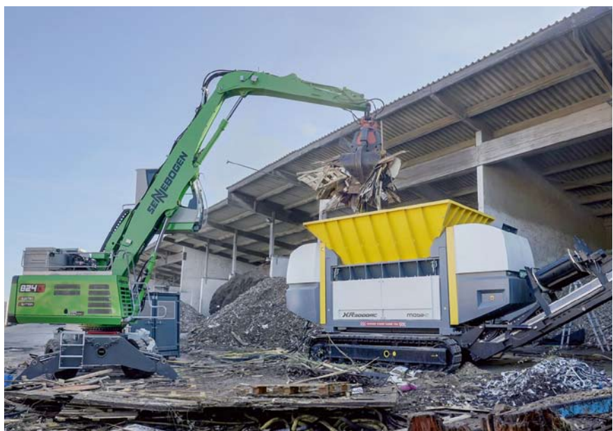
Sennebogen-Umschlagbagger, Untha Power Core und Untha XR mobil-e im gemeinsamen Einsatz
