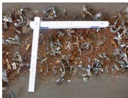
Der Rotorshredder von BHS zerkleinert die Meatballs zuverlässig. Spezielle Anpassungen in Maschinenaufbau verhindern, dass sich die Teile verhaken
