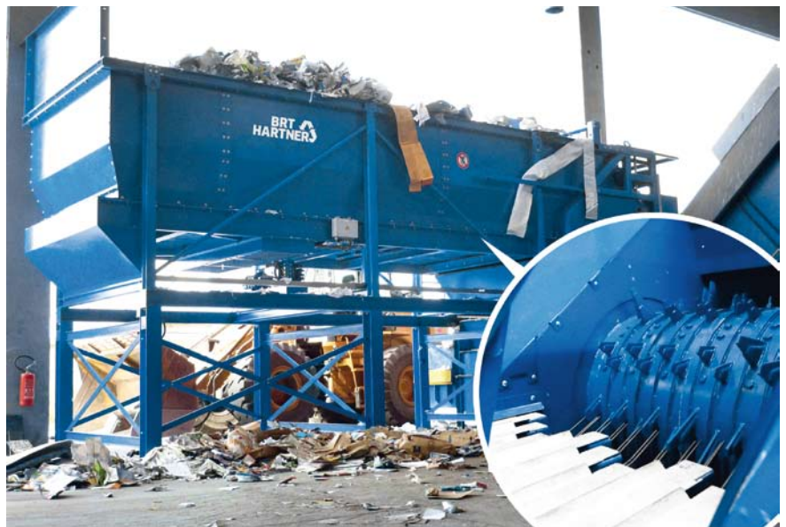
Die entscheidenden Werkzeuge zum Öffnen der Säcke sind die Aufreißfinger auf der Trommel und die Aufreißdreiecke auf den Anpressarmen
