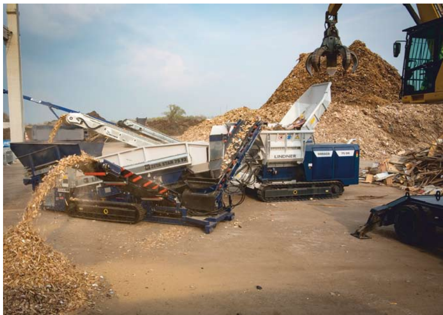
Die mobile Systemlösung, bestehend aus dem Zerkleinerer Urraco 75 DK und dem Sternsieb Zeta Star 75 F2 DK, ermöglicht die Produktion von sauberem P63-Endkorn bei einem Durchsatz von bis zu 25 Tonnen pro Stunde
