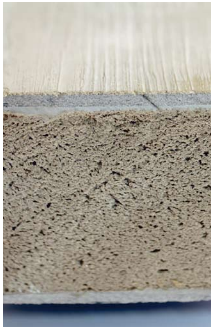
Sandwichelement aus Holzschaum und Textilbeton als Deckenlage
