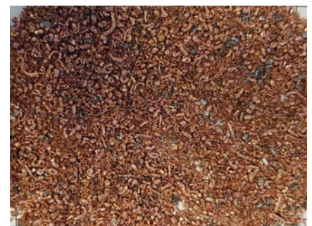
Mit dem von BHS-Sonthofen optimierten Verfahren zum Recycling von Meatballs lässt sich qualitativ hochwertiges Kupferkonzentrat gewinnen
