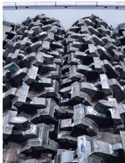
Die speziell für die Aufbereitung von Leichtschrott weiterentwickelten Zerkleinerungswellen des mobilen Shredders Urraco 95 DK sorgen für lange Standzeiten und maximale Produktivität
