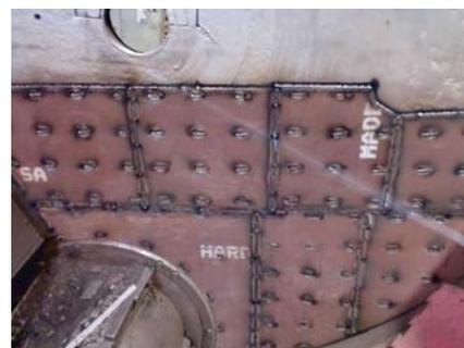
Nachher: Mit dem Cutmetall Reparatur-Kit lässt sich das Gehäuse der Maschine leicht und schnell verkleiden
