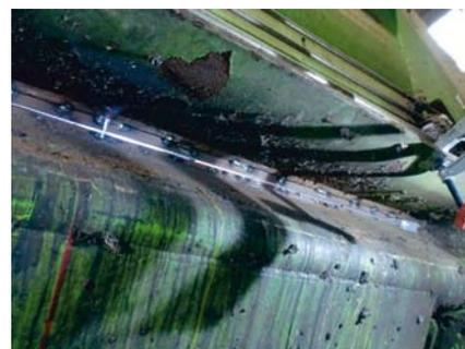
Vorher: Blick in das verschlissene Gehäuse eines Zerkleinerers
