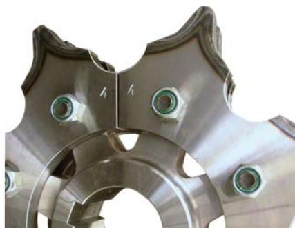
„Unsere wendbaren Kettenräder mit symmetrischer Zahnform verdoppeln die Lebensdauer. Zudem haben wir die Materialgüte erhöht und dadurch eine wesentliche Lebensdauerverlängerung erreicht“, betont FB-Kettenprofi Daniel Zahnd. Diese Optimierung hat schon zu einer Reduktion der Betriebskosten geführt, war jedoch noch nicht die Lösung, die sich Ernst Kundert und er vorgestellt hatten.
