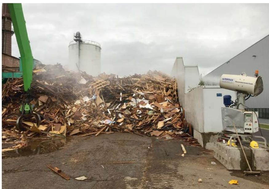
Staubbindemaschinen garantieren eine flächendeckende Staubbindung durch Wasservernebelung
