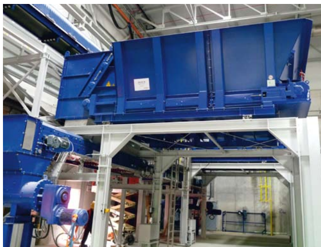
Annahmedosierer für Kranbeladung als Aufgabebunker
