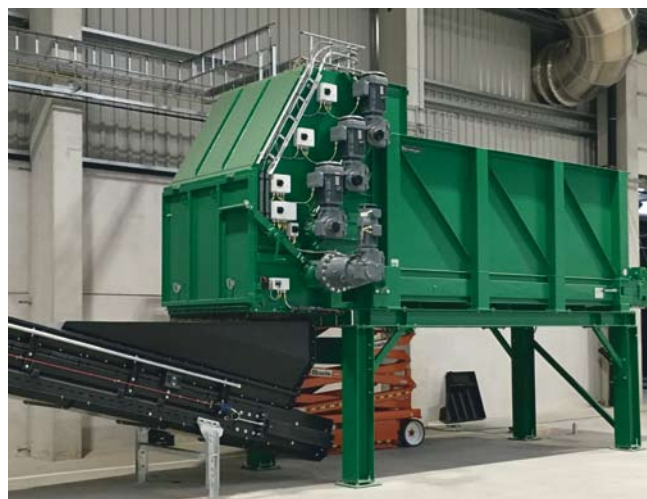
Annahmedosierer für Radladerbeladung als Aufgabebunker
