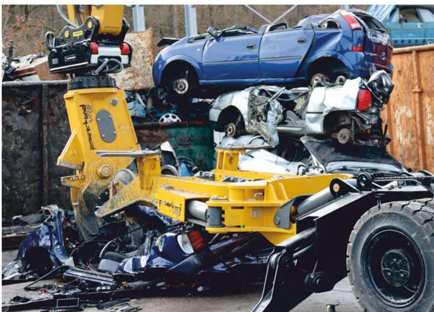
Klemmarme, die am Unterwagen des Umschlagbaggers angebracht sind, fixieren das Fahrzeug, während von oben die Pinzette die Karosserie auseinandernimmt
