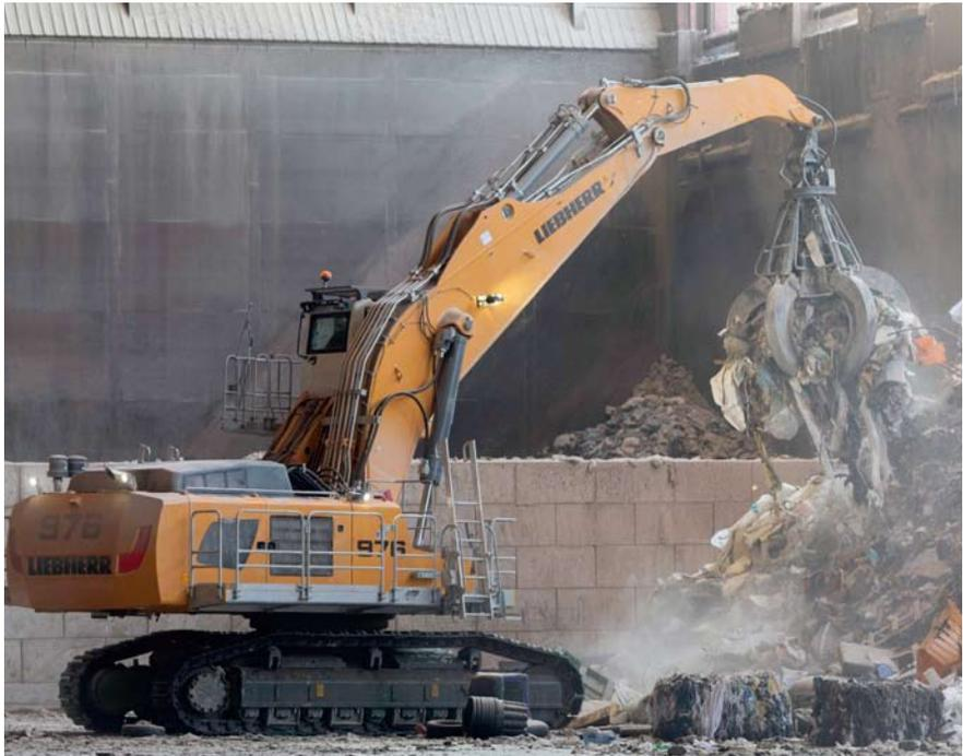
Dieser R 976 Raupenbagger wurde für den Einsatz in einer Abfallsortieranlage bei Veolia angepasst: Kabinenerhöhung, Laufsteg, individuelle Arbeitsausrüstung und Werkzeuge
