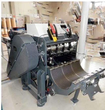
Scherschnittmühle RS 38060 HZ mit geöffnetem Siebwagen
