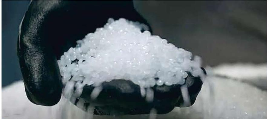
Kunststoffpellets für neue Produkte: Sie werden aus Gas hergestellt, das wiederum aus dem gemischten brennbaren Abfall stammt, der auf 600-800 Grad Celsius erhitzt wird
