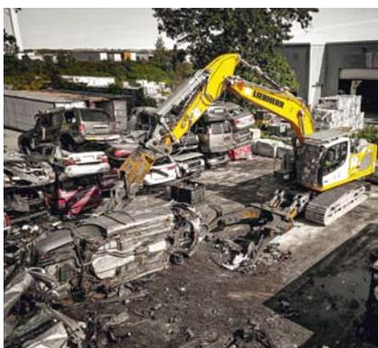
Der R 922 Raupenbagger mit Powerhand-Greifer zur Zerlegung von Fahrzeugen
