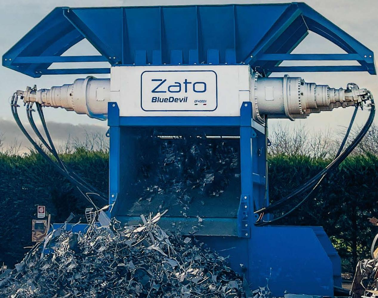
Zato **Blue Devil**, die ideale Lösung ihren Zerkleinerungs-Prozess auf den nächsten Level zu bringen. Als Zuverlässige Maschine wird er den Eisen- und Ne-Schrott problemlos zerkleinern und in wesentlich besseres weiterverarbeitbares Material verwandeln. Schnelle Lieferzeiten, unkomplizierter Aufbau und umfassende Fernwartung machen den Zato Zerkleinerer zu einem Gewinn für Ihr Unternehmen.
