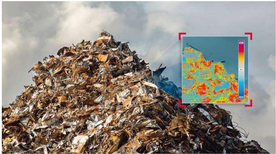
Mittels Thermalkameras wird die Oberflächentemperatur des Haufwerks überwacht und darauf geachtet, dass ein bestimmter Temperaturwert nicht überschritten wird
