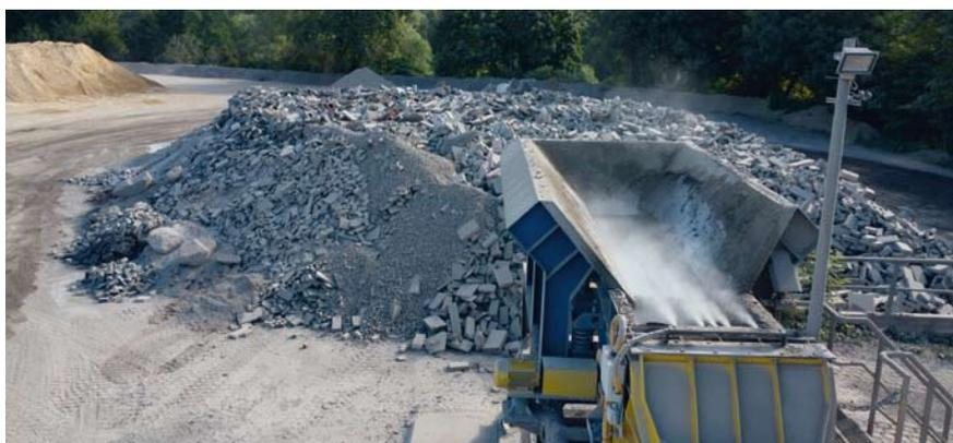
Stationäre Anlagen sind fest an der Anlage verbaut. Bei der Brecherenebelung wird während der Materialaufgabe in den Brecher genebelt
