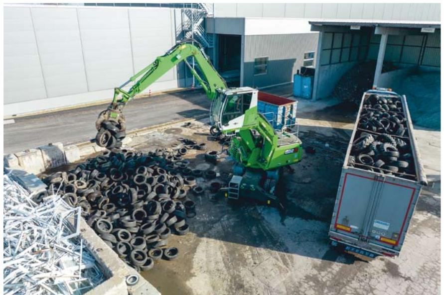
Die hochfahrbare Kabine ermöglicht eine optimale Sicht und eine präzise Befüllung des Containers
