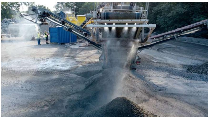
Bandabwurfenebelung: In das vom Band fallende Material wird Wassernebel eingebracht; so werden Staubaufwirbelungen vermieden und es kommt zu einer geringeren Staubentwicklung. Der Wassereintrag ist durch Düsenanzahl, Düsengröße und Wasserzufuhr sehr effizient steuerbar
