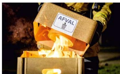
pe von Afvalbox hingegen besteht aus dicht gewickeltem und gepresstem Karton (ohne offene Zellen), wodurch eine äußerst stabile Masse entsteht. Damit entspricht er der Brandschutzklassifizierung EN 13501-1. Darüber hinaus wurde aus dem gleichen Material ein Kartondeckel mit Einführungsöffnung entwickelt, der eine flammenlöschende Wirkung hat, sollte sich der Inhalt des Sammelbehälters entzünden.
