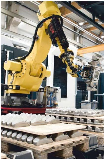
Im neuen Werk wird verstärkt auf neueste Automatisierungstechnologie und Robotik gesetzt. Mit der 5-Achs-Simultan-Fräsmaschine wird die vollautomatische Produktion von Schredder-Komponenten wie Messer- und Messerhalter ermöglicht
