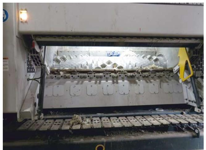
Produktportfolio. Bei geöffneter Klappe ist der Nachdrücker durch die Klappe selbst arretiert, damit er nicht ungehindert runterfährt.
