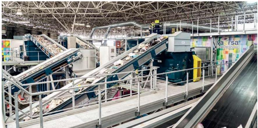
Ballistikseparatoren von Stadler, welche die flexiblen und dreidimensionalen Materialien trennen, Magnet- und Wirbelstromabscheidern, die Metalle in Eisen- und Nichteisen-Fractionen sortieren, sowie optischen Sortierern, die Wertstoffe erkennen. Das Output-Material wird in die Fractionen PET, HDPE, Folie, Tetra Pak, gemischte Kunststoffe, Eisen- und Nichteisenmetalle separiert. Am Ende des Prozes-
