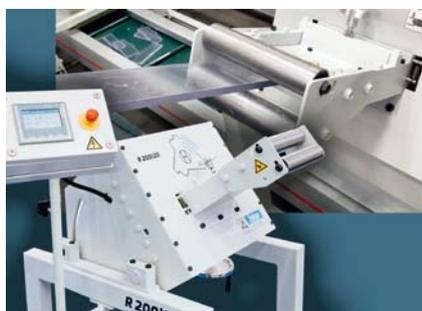
Per Touch-Display lassen sich die Zykluszeiten der mit einem Servo-Getriebemotor ausgestatteten Randbeschnittanlage R 200/20 von Hellweg jetzt frei vorgeben
