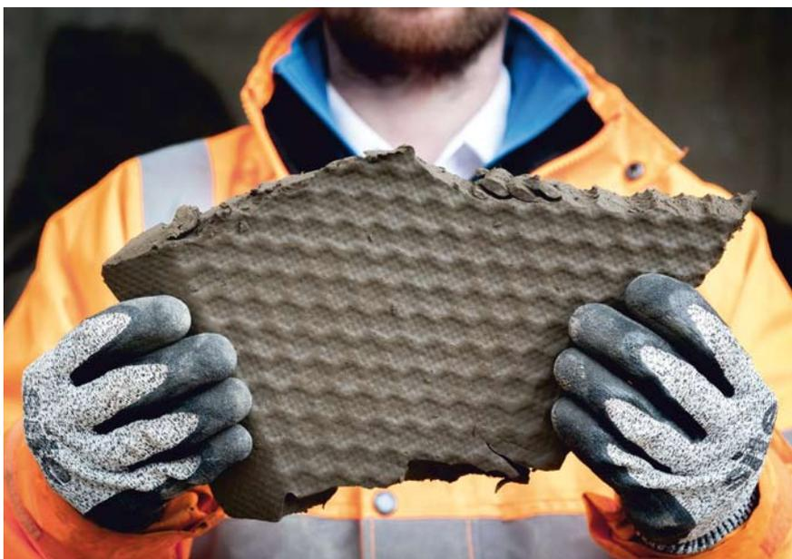
Mit der ProPress von CDE können Betreiber bis zu 95 Prozent des Prozesswassers in der Waschanlage zur sofortigen Wiederverwendung recyceln und gleichzeitig Kosten für die Abfallentsorgung reduzieren, indem sie ein Produkt aus dem Filterkuchen gewinnen, das für Rohrbettungen und Deponieabdeckung verwendet werden kann. Auf diese Weise machen sie Absetzbecken überflüssig, die in der Regel eine umfangreiche Instandhaltung erfordern, Arbeitsressourcen verbrauchen und erhebliche Kosten verursachen.
