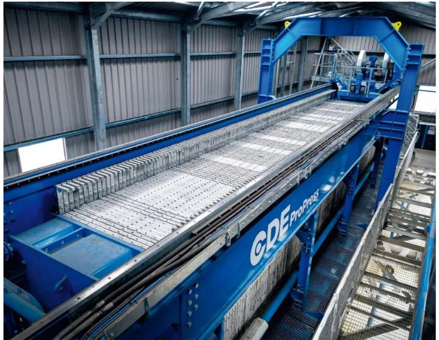
optimierter Schlamm-Einspeisedruck ermöglicht zudem eine schnellere Entwässerung und erhöht den Gesamtdurchsatz. Beim Waschen und Klassieren von Materialien sammelt das Wasser aus diesem Prozess Schluff und andere Rückstände an und bildet einen Schlamm. Dieses schwer zu verarbeitende Material wird unter hohem Druck in die ProPress gepumpt, die
