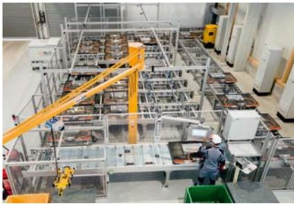
Das Transfer-system TS 5 von Bosch Rexroth transportiert die Batteriemodule unterschiedlicher Hersteller, Größen und Typen zwischen den
