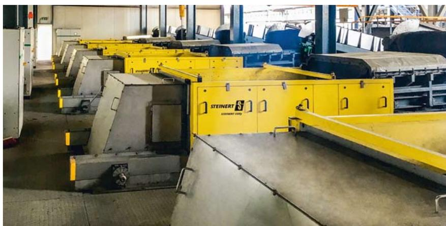
Bis zu vier Wirbelstromscheider lassen sich mit einer Splitcontrol-Steuereinheit regeln
