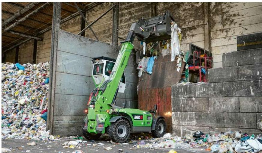
Mit dem Teleskoparm und der hochfahrbaren Kabine lässt sich der Shredder sicher und effizient beschicken – selbst aus großer Höhe
