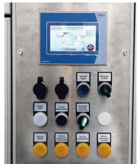
Farbiger Touchscreen und jede Menge Sensoren: Ausschnitt aus dem Bedienfeld einer großen Zentralmühle mit integrierter Zu- und Abfuhrtechnik
