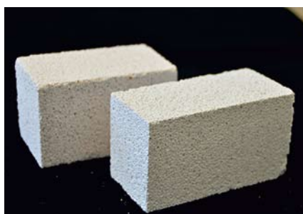
Porenbeton aus Ziegel (hinten), Porenbeton aus Kalksandstein (vorne)
