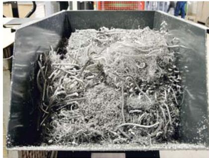
An jedem Bearbeitungszentrum nehmen standardisierte und mit Rollen versehene 400-Liter-Behälter die Aluminiumspäne auf
