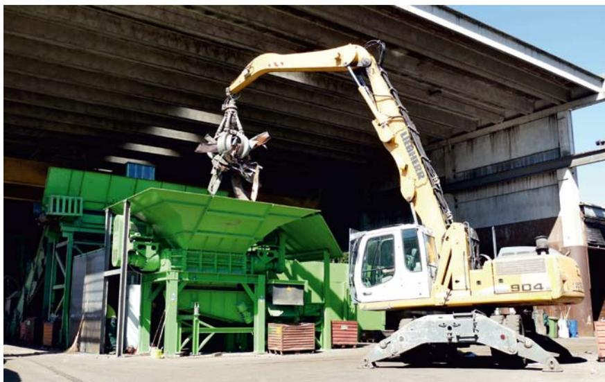
Das Input-Material wird nun mittels Bagger mit einem Polygreifer in den Trichter des Reißers befördert – die Steuerung des RM1350/2-2000 erfolgt dabei bequem mithilfe einer Fernbedienung vom Führerhaus des Greifers aus
