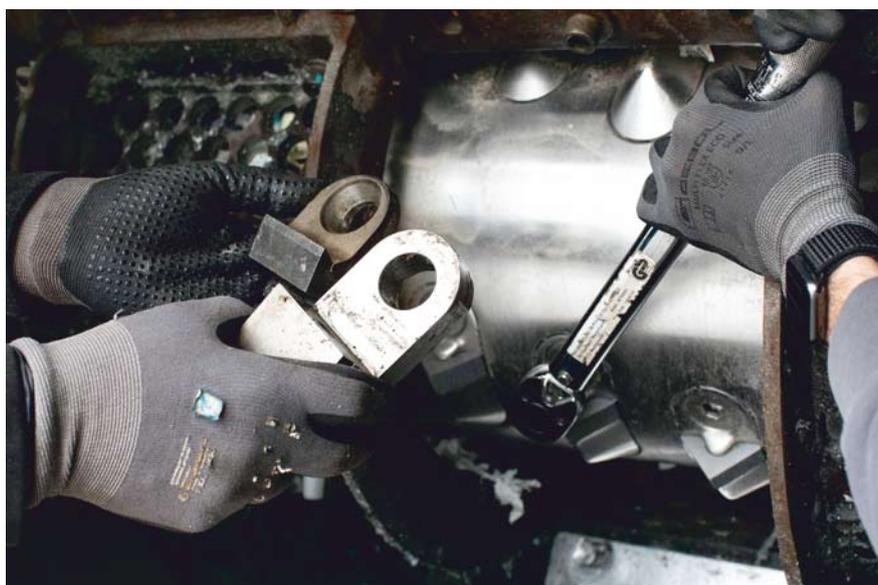
Die Kombination unterschiedlicher Messergeometrien ermöglicht eine optimale Anpassung an die zu zerkleinernden Kunststoffe
