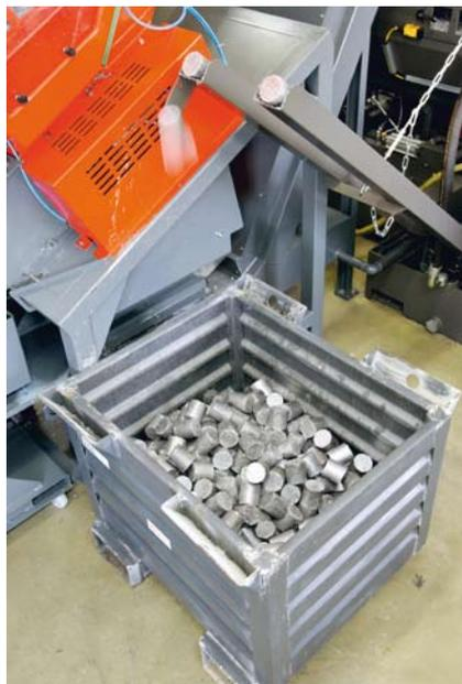
Handliche und trockene Briketts statt voluminöser nasser Späne: Mit der RUF-Presse vereinfacht Euler das Handling der Produktionsreste stark
