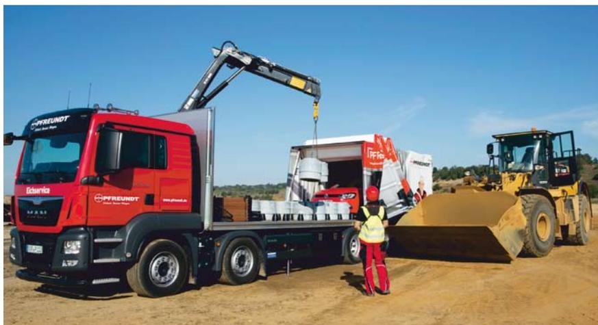
Eich-Lkw, ausgestattet mit Kran und 15 Tonnen geprüfter Eichgewichte
