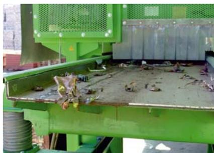
Nach der Zerkleinerung fällt das Material auf eine Vibrationsförderrinne direkt unter der Anlage
