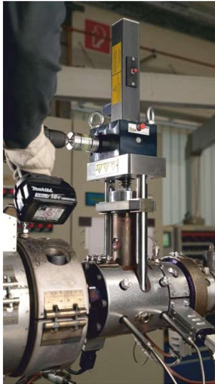
Der Siebwechsler ist gefahrlos manuell zu bedienen. Zur leichteren Montage kann beispielsweise auch ein Akkuschauber verwendet werden
