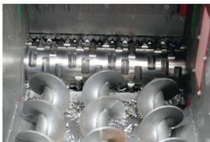
Direkt unter den Schnecken werden Feinspäneanteile automatisch ausgesiebt, was das Schneidwerk zusätzlich entlastet
