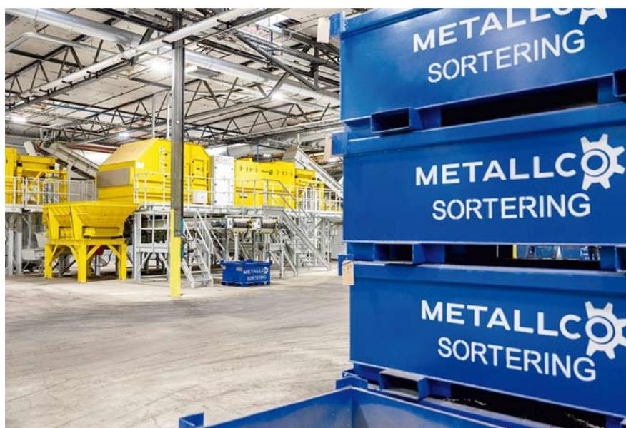
Beide Steinert XSS T EVO 5.0 erzeugen bei Metallco reines Aluminium. Schwermetalle werden aussortiert und anschließend Guss- und Knetaluminium getrennt
