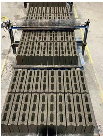
Bei der Werksfertigung wurden bis zu 40 Massenprozent der natürlichen Gesteinskörnungen durch Recyclingmaterial ersetzt. Die technischen Eigenschaften der erzeugten Produkte können den einschlägigen Normen und Zulassungen zugeordnet werden
