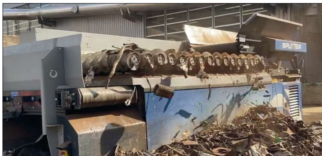
Schrott-Recycling mit dem SPLITTER HOOK Mobiles 2/3-Fraktions-Spiralwellensieb
