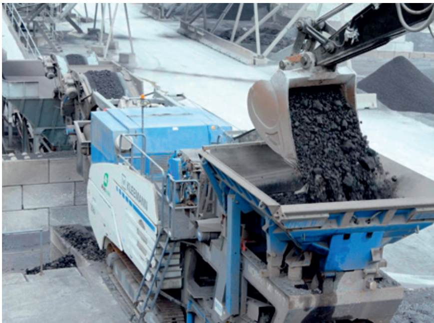
Der Prallbrecher von Kleemann hält der extrem abrasiven Schlacke stand
