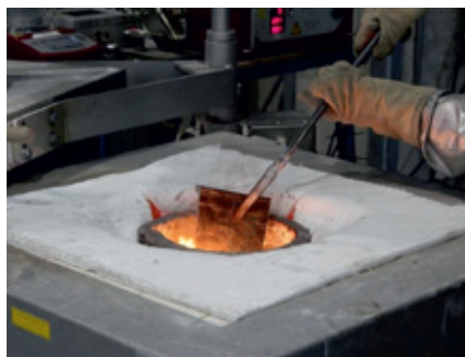
Eine zerkleinerte Felge wird im Ofen eingeschmolzen
