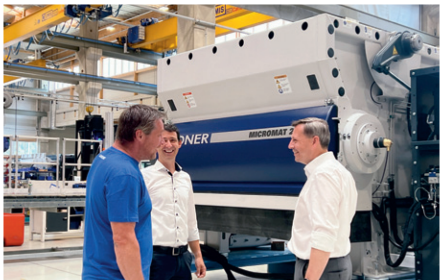
Die Micromat-Serie von Lindner hat sich als zuverlässige Lösung für das Zerkleinern von Kunststoffen etabliert
