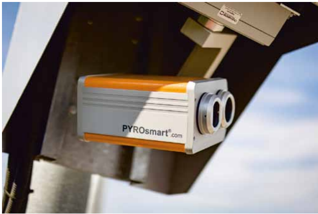
Die PYROsmart®-Systeme von Orglmeister überwachen die Freiflächen am Standort Premstätten
