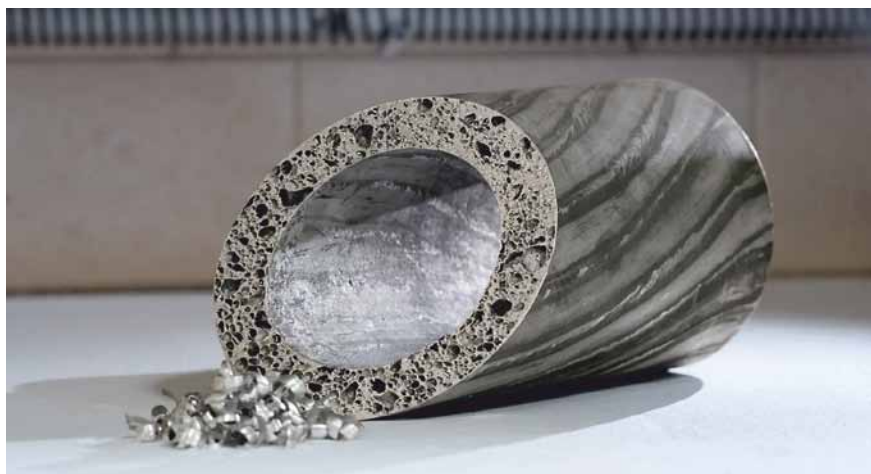
Hohe geometrische Freiheitsgrade beim Design von Aluminiumschaum-Sandwiches
