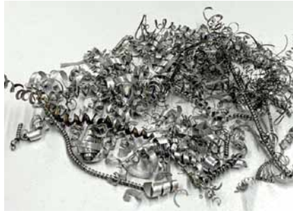
Aluminiumlegierungsspäne als Ausgangsmaterial für hochwertigen Leichtbau
