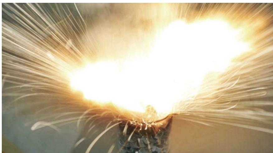
Stichflamme bei der Explosion eines Lithium-Ionen-Akkus (Typ 18650). Lithium-Ionen-Akkus auf Wasserbasis wären ungefährlicher in der Handhabung und zugleich leichter zu rezyklieren
