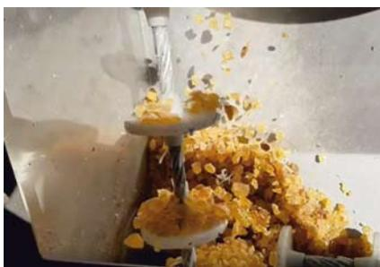
Beim vertikalen Eintritt in die Umlenkstation fallen die Materialien von den Mitnehmerscheiben, um anschließend über die darunter verlaufende horizontale Streckenführung mitgenommen zu werden
