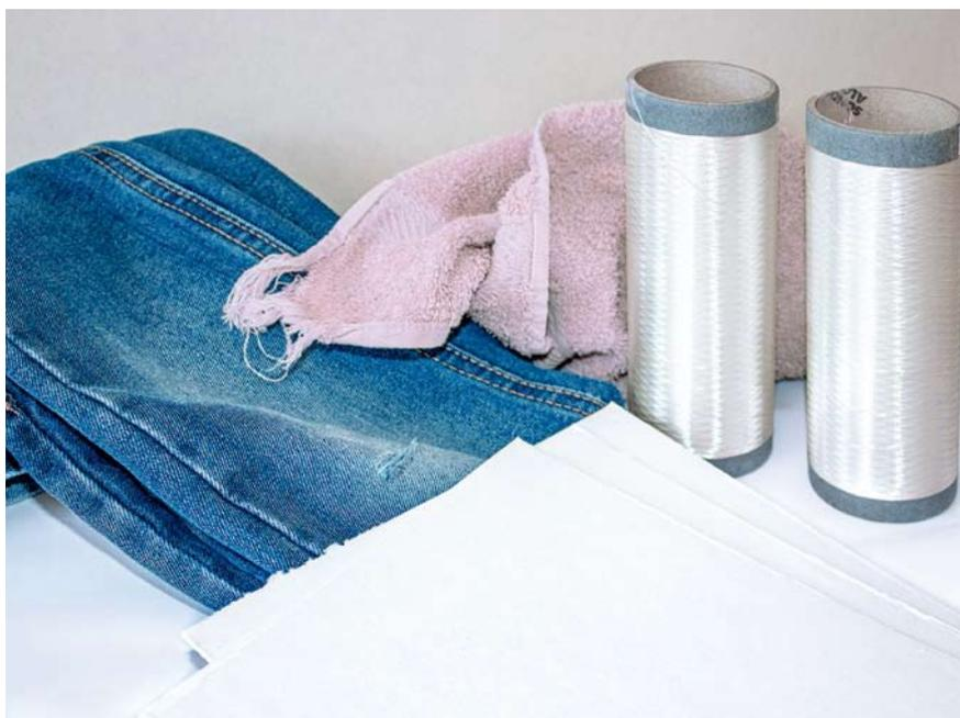
Das aufgespulte Viskose-Filamentgarn wurde aus recycelter Baumwolle gefertigt, die in Form von Zellstoffplatten vorliegt
