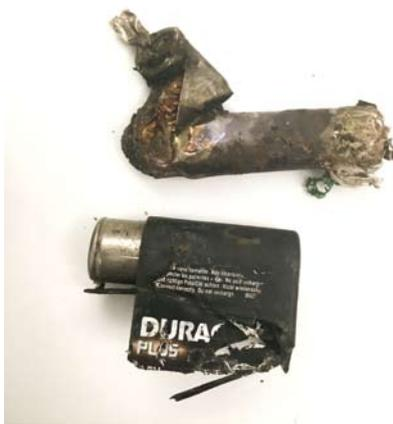
Durch den mechanischen Aufbereitungsprozess beschädigte Akkus und Batterien stellen ein enormes Brandrisiko bei der EBS-Produktion dar
