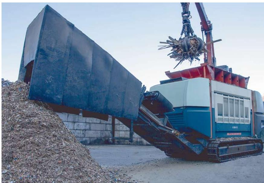
Zerkleinerer Untha XR3000C mobil-e bei Korn Recycling
