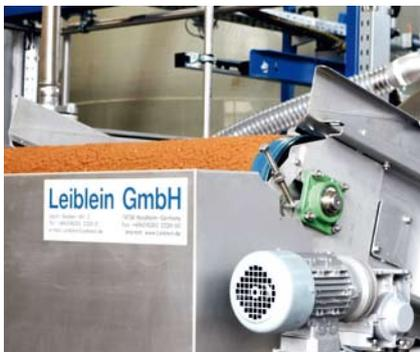
Nach Filtration des Abwassers im unteren Bereich des Filterbandes baut sich ein Filterkuchen auf, der fachgerecht entsorgt wird
