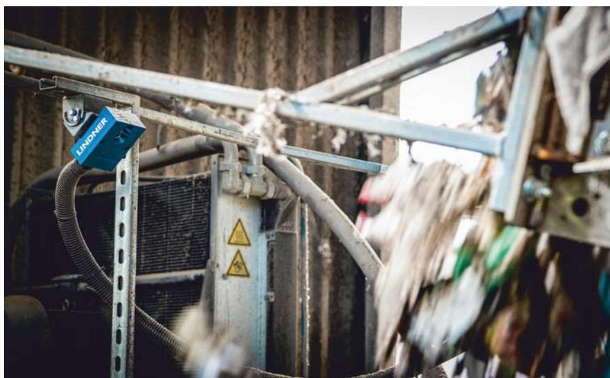
Der Sensor des FPS nach der ersten Zerkleinerungseinheit erkennt überhitzte Partikel frühzeitig
