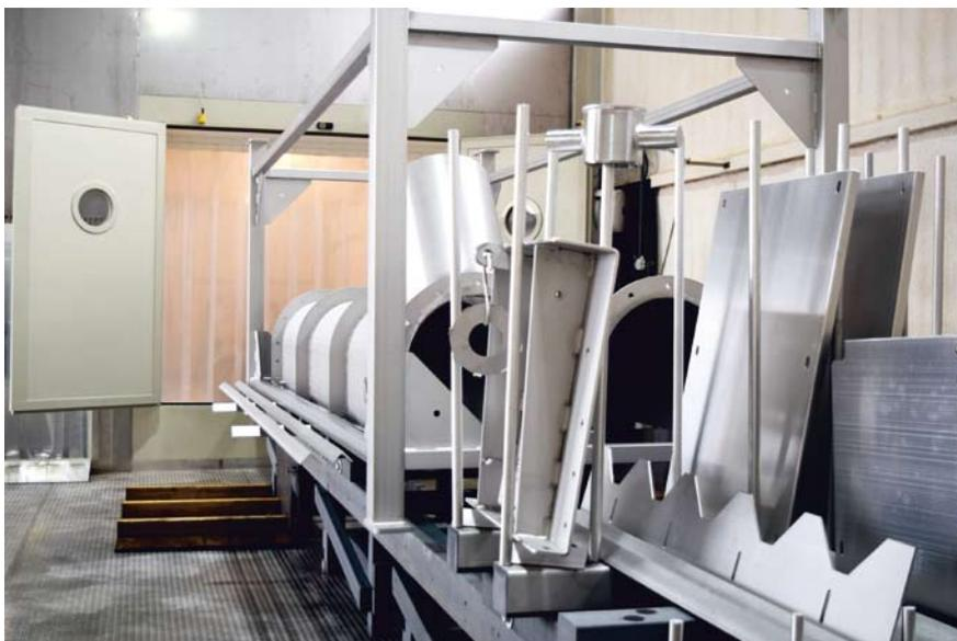
Mit Zuführung einzelner Bauteile in die Edelstahl-Beisanlage erfolgen Entfetten, Beizen, Passivieren, Spülen und die Luftreinigung vollautomatisch
