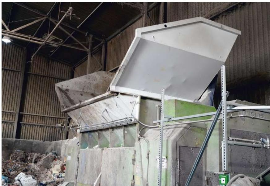
Vorzerkleinerer, der gemäß dem erarbeiteten Schutzkonzept ausgerüstet wurde
