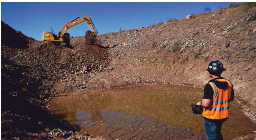
Die Cat-Command-Konsole ermöglicht dem Bediener ein sicheres und bequemes Steuern aller Maschinenfunktionen abseits der Maschine
