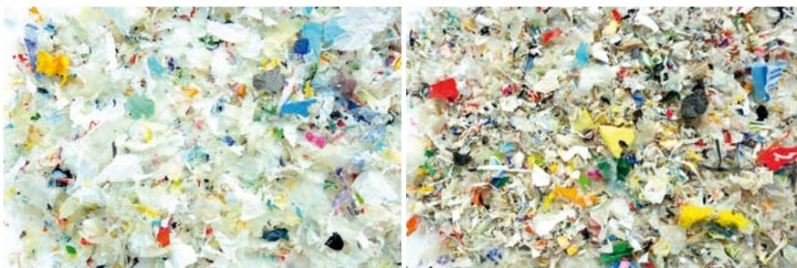
Die Fraktionen nach der Windsichtung: recycelbares Polyethylen (links) und Materialmischung mit Mehrschichtfolien (rechts)
