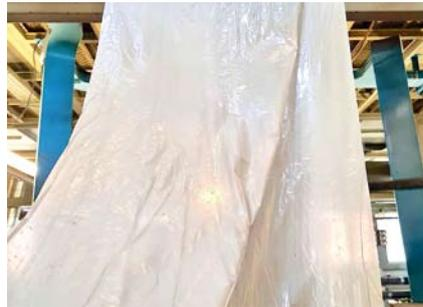
Folienextrusion mit Granulat, das mit Hilfe der neuen Pla.to-Trennanlage aus recycelten Mehrschichtfolien (Fraktion 310) gewonnen wurde
