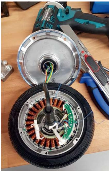
Beim E-Scooter befindet sich der Elektromotor im Reifen. Die Magnete sind die silbernen Quader außen an den Kupferwicklungen
