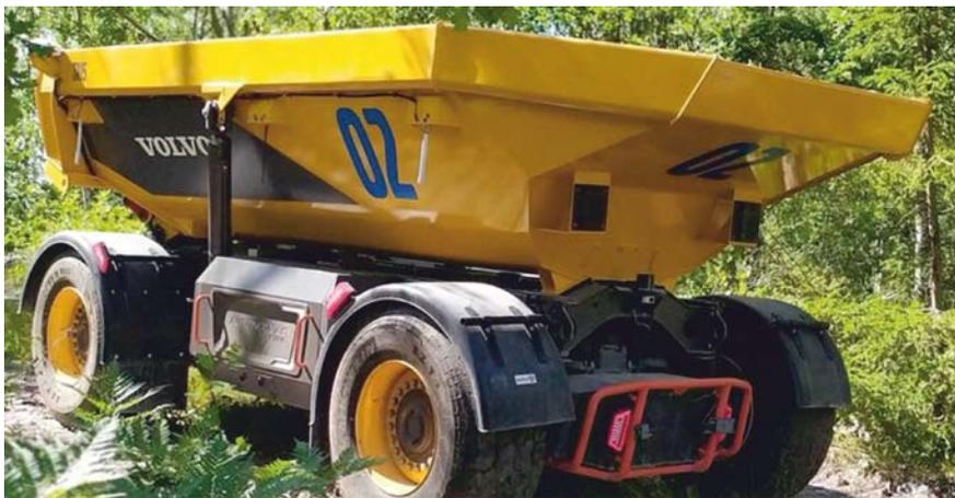
Der autonome und elektrisch betriebene Lastenträger TA15 benötigt keine Fahrerkabine mehr
