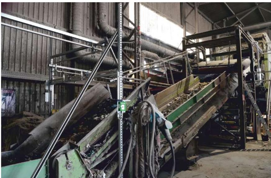
Glutnest- und Hot-Particle-Detektion über hochsensible T&B Detektoren auf dem Austragsband in Kombination mit flächendeckender Löschung hinter einem Nachzerkleinerer
