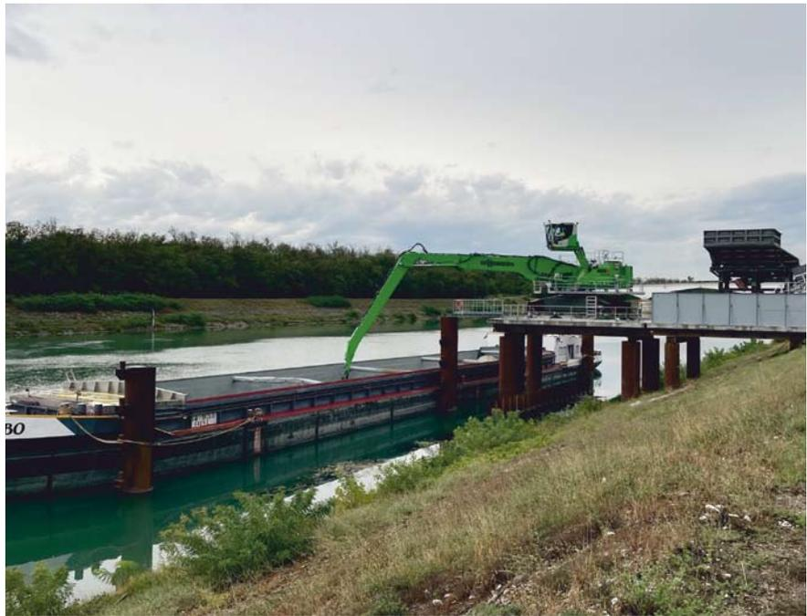
Problemlos entlädt der 855 E den Schiffsrumpf und beschickt die Container sowie den erhöhten Trichter, über den das Material auf die Fließbänder der Recyclinganlage gelangt
