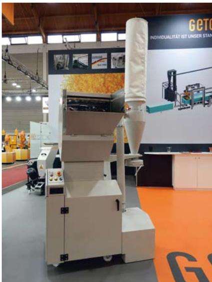
Die auf Rollen verfahrbare RS 2404 hat einen 5,5 kW-Antrieb und ist für einen Stundendurchsatz von bis zu 160 Kilogramm ausgelegt
