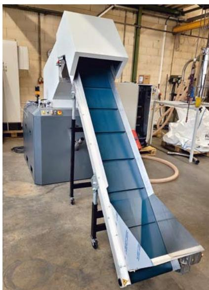
Die RS 30040 ist für einen Durchsatz von bis zu 360 Kilogramm pro Stunde konzipiert. Auf der Fakuma präsentiert sich eine Variante zur Zerkleinerung von massiven Teilen
