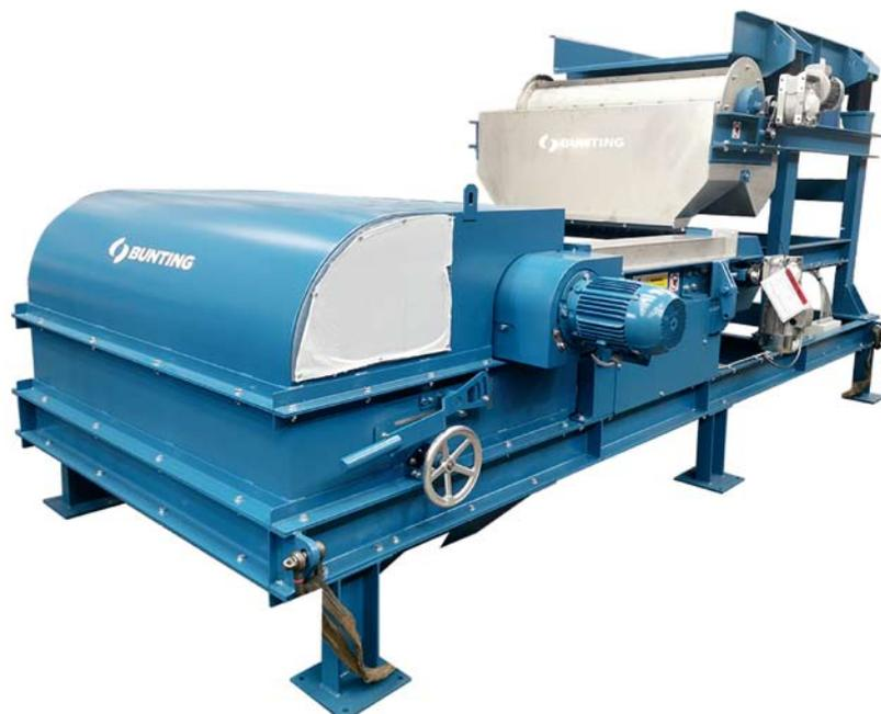
erfüllen, betragen die Einzugsbreiten sowohl des Trommelmagneten als auch des Wirbelstromabscheiders 1.250 Millimeter. Die gesamte Ausrüstung ist auf einem gemeinsamen Rahmen mit einem einzigen Bedienfeld
