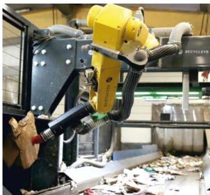
Zwei Roboter werden über einer Faserlinie installiert, um Nicht-Papierartikel wie Kunststoffe, Dosen und Pappe zu sammeln und so die Anzahl an Störstoffen zu reduzieren. Die anderen beiden Roboter werden in einer Reststofflinie eingesetzt, wo sie gezielt wiederverwertbare Materialien aussortieren.
