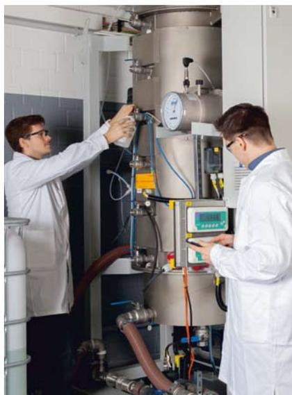
Forscher der FH Münster am Hochlastfermenter der Versuchsbiogasanlage in Saerbeck
