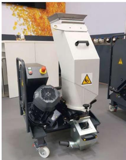
Die Beistellmühle GRS 180 A verfügt über Verschleißschutzplatten im Trichter, sodass sie es im Zusammenspiel mit den verschleißgeschützten Hartmetall-Messern ihres Sieben-Messerrotors auch mit abrasivem Material aufnimmt
