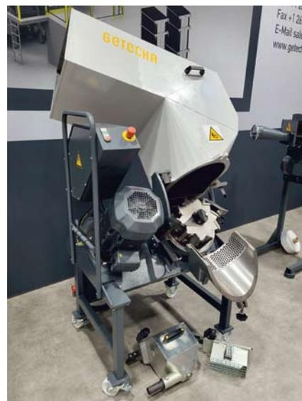
Bei der GRS 300 A GETECHA – hier im geöffneten Zustand – erlaubt der geneigte, von einem 5,5 kW-Motor angetriebene Zehn-Messerrotor selbst in teilgefülltem Zustand das Anfahren des Systems
