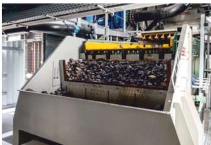
Blick ins Innere der Bodenwaschanlage: Die nassmechanische Aufbereitungsanlage von Max Wild reinigt Gleisschotter und gering belasteten Bodenaushub
