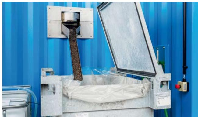
Nach der Schockwellenbehandlung kann die abgetrennte Metallfraktion abgeschieden und in einen Lagerbehälter ausgeschleust werden
