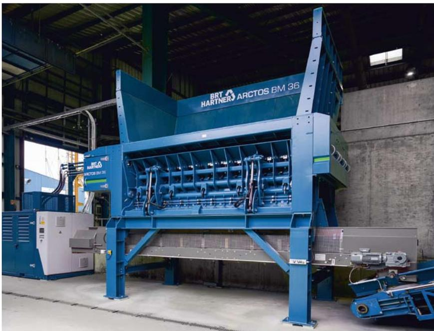
Die neuen Arctos von BRT Hartner sind in Höhe und Breite optimal auf die großvolumige Beschickung mit Radladern ausgelegt
