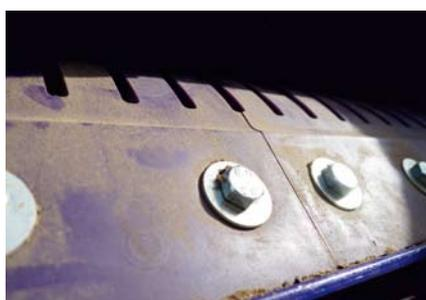
Der CFC-Abstreifer: Der Chevron Belt Finger Cleaner steht in direktem Kontakt mit dem laufenden Band
