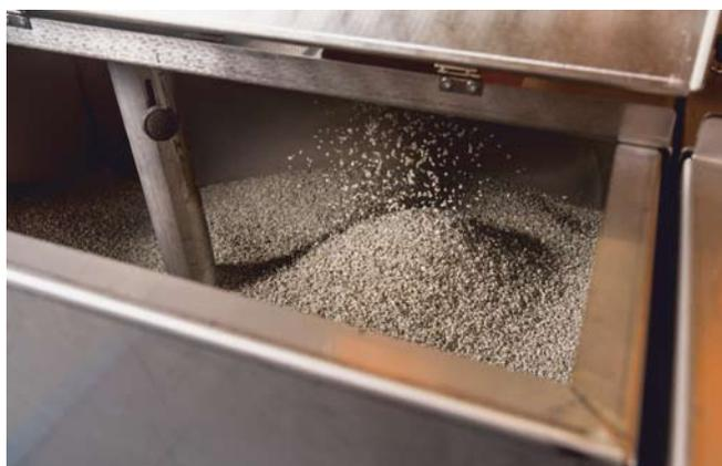
Im letzten Schritt werden die einzelnen Stofffraktionen mittels Magnetabscheidung voneinander getrennt
