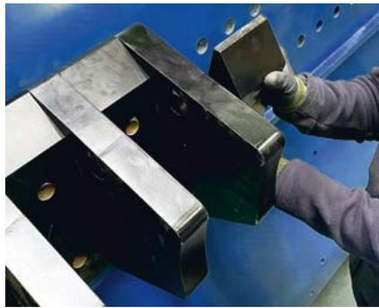
Alle relevanten Verschleißelemente der Arctos Zerkleinerer können mittels Steck- und Schraubsystem schnell ausgetauscht werden
