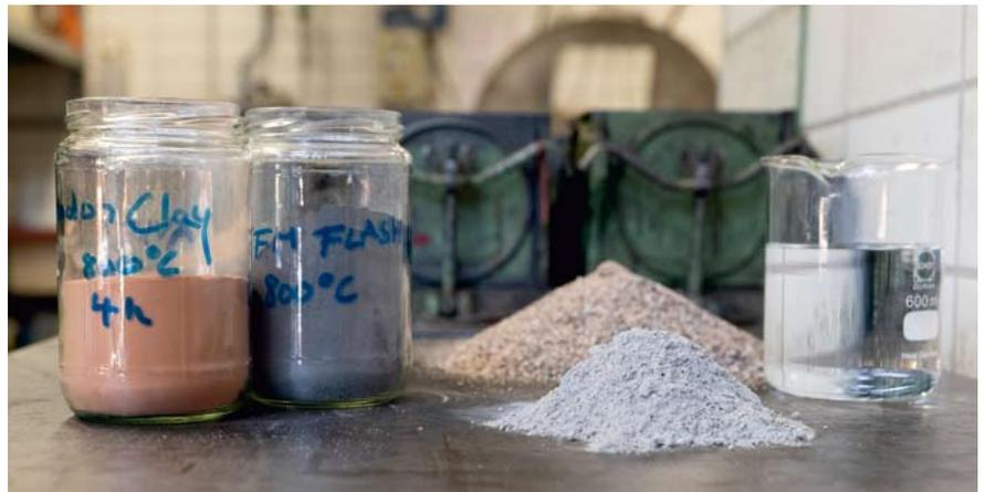
Im Projekt „Toffee“ wurde untersucht, ob sich Aushubmaterial von Tunnelarbeiten als Zusatzstoff in Betonen eignet
