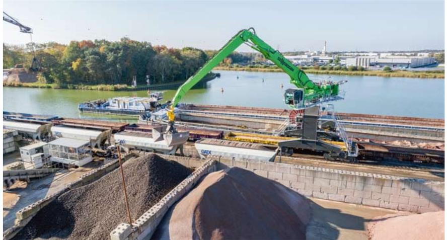
Am Standort Ibbenbüren-Uffeln, direkt am Mittellandkanal, der längsten künstlichen Wasserstraße Deutschlands, wurde die neue Maschine auf einem 340 Meter langen Kai mit angrenzender Lagerhalle und Bahnanschluss installiert. Der Sennebogen 870 E auf Schienenportal übernimmt am Standort die Verladung von Schüttgut zwischen Binnenschiff und Güterzug und ersetzt sukzessive zwei ältere Krananlagen.
