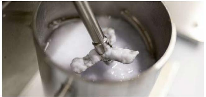
Ein wichtiger Verarbeitungsschritt bei der Bewertung der Recyclingfähigkeit von faserbasierten Verpackungen ist die Auflösung des ofengetrockneten Probenmaterials in Leitungswasser
