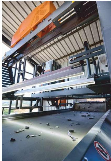
Das neue System verarbeitet Korngrößen von 6–120 mm mit einem Durchsatz von bis zu 20 t/h bei Zorba-Material
