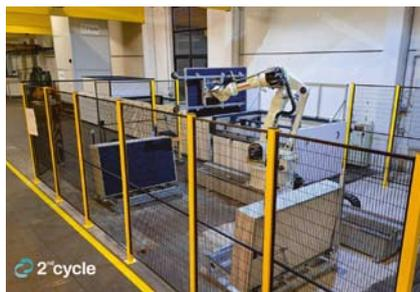
Upcycling Anlage für Photovoltaikmodule bei der Firma 2nd cycle
