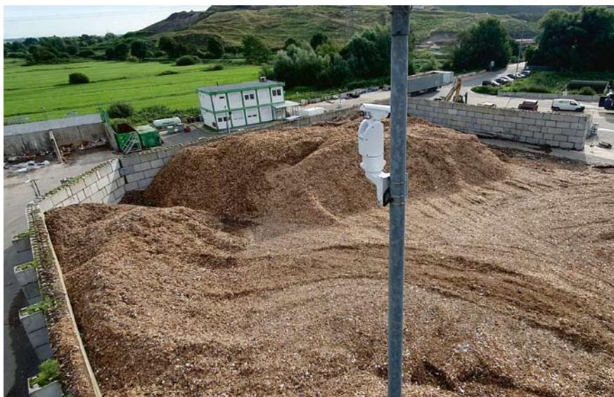
Das Brandfrüherkennungssystem RED Fixed überwacht mit einer drehbaren thermografischen Kamera die Temperaturentwicklungen auf dem Nehlsen-Betriebsgelände am Fahrwiesendamm in Bremen
