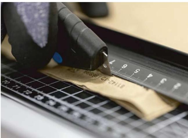
Im ersten Schritt des Prüfverfahrens zur Recyclingfähigkeit werden drei mal drei Zentimeter große Quadrate aus dem faserbasierten Probenmaterial ausgeschnitten
