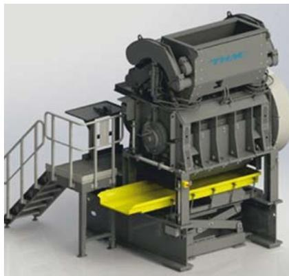
Granulator Typ ZMK2007 mit Pendelnachdrückeinrichtung
