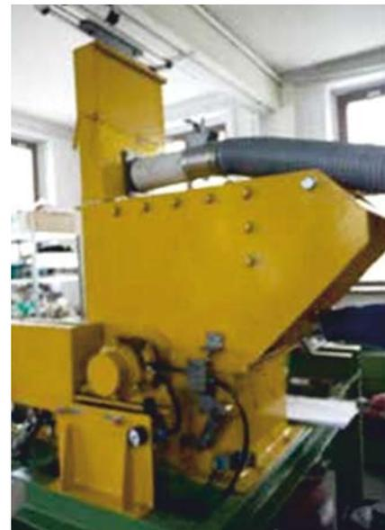
Kleintechnische Hammermühle der Gebr. Jehmlich GmbH
