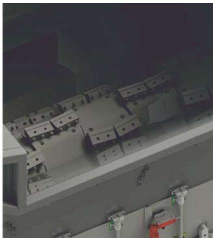
Schneidwerk eines Universal Granulators Typ XG2400
