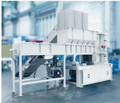
heit wird das Aufgabematerial der Schredder-Schneidmühlen-Kombination selbstdosierend abgegeben. Entsprechend der Aufgabenstellung kann die Zufuhr individuell angepasst werden. Das vorzerkleinerte Material gelangt nach Passieren der Schred-
