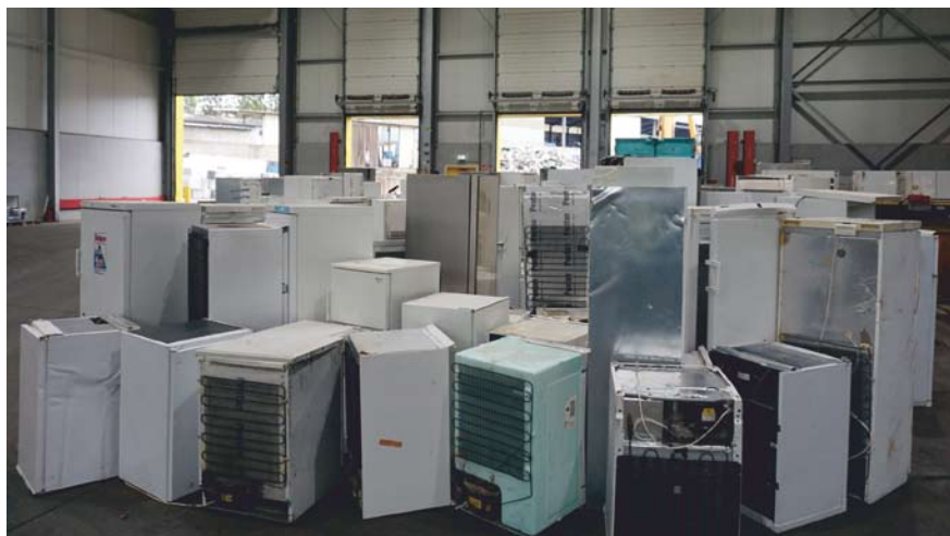
Die Kühlschränke bedürfen einer Vorselektion: Im Isolierschaum der älteren Modelle befindet sich FCKW
