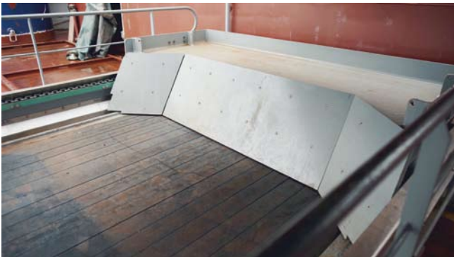
Die Geröll-Räumplattform auf der Vox Amalia bei Van Oord schiebt das schwere Geröll über Bord
