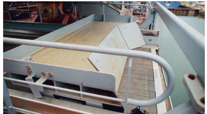
Das 2-in-1-Kettenantriebssystem RUD Tecdos Pi-Gamma aus einsetzgehärtetem Stahl treibt die Geröll-Räumplattform an
