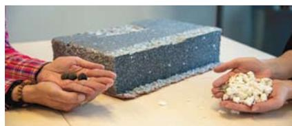
Werden Wärmedämmverbundsysteme (Mitte) im Zementwerk verwertet, kann der enthaltene Putz zur Herstellung von Klinkerstein (links) verwendet und das EPS (rechts) energetisch genutzt werden
