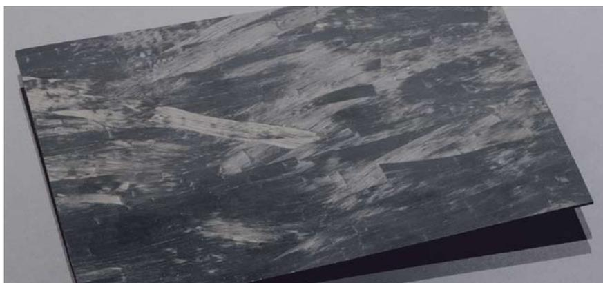
Das mit dem neuen Recyclingverfahren gefertigte Tape ermöglicht die Herstellung von hochbelastbaren Bauteilen mit in Belastungsrichtung orientierten Fasern
