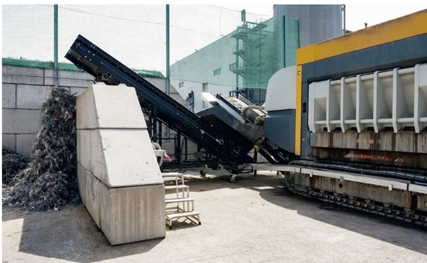
Der Überbandmagnet des Zerkleinerers holt Metallteile aus dem Granulat heraus; so können die separierten Materialien anschließend stofflich oder thermisch verwertet werden
