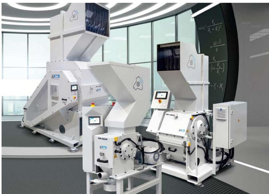
Von der kleinsten bis zur größten: Die Smart-Control-Steuerung steht für alle Mühlen von Hellweg zur Verfügung
