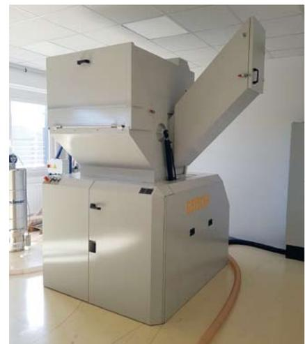
Die stündliche Durchsatzleistung der Einzugs-mühle RS 30090-E beträgt bis zu 670 Kilogramm. Diese Materialmenge bewältigt sie mit einem frequenzgeregelten, wassergekühlten 30kW-Antrieb
