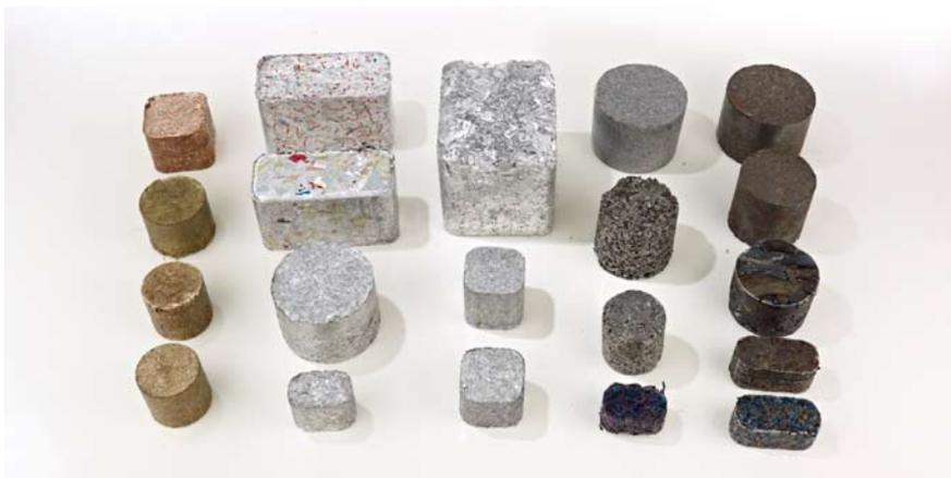
Neben Aluminium verpressen Ruf-Anlagen auch Stahl, Edelstahl, Guss, Kupferwerkstoffe, Magnesium sowie Titan
