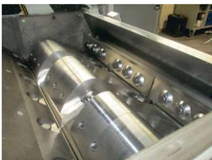
Im Mahlraum der RS 45090 arbeitet ein massiver Dreimesser-Rotor mit Schwungmasse und zusätzlichem dritten Statormesser. Er ist ausgelegt für die Zerkleinerung stark verrippter Teile und verhindert ein allzu tiefes Eintauchen der Reststücke
