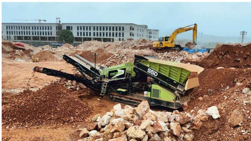
Die S5D von Mesda mit dieselhydraulischem Antrieb setzt bis zu 400 Tonnen pro Stunde durch – je nach Aufgabematerial. Zur Standardausstattung gehört ein widerstandsfähiger, im Arbeitswinkel verstellbarer Doppeldecker-Siebkasten mit hoher Amplitude. Extra lange, hydraulisch klappbare Austragsbänder sorgen für maximale
