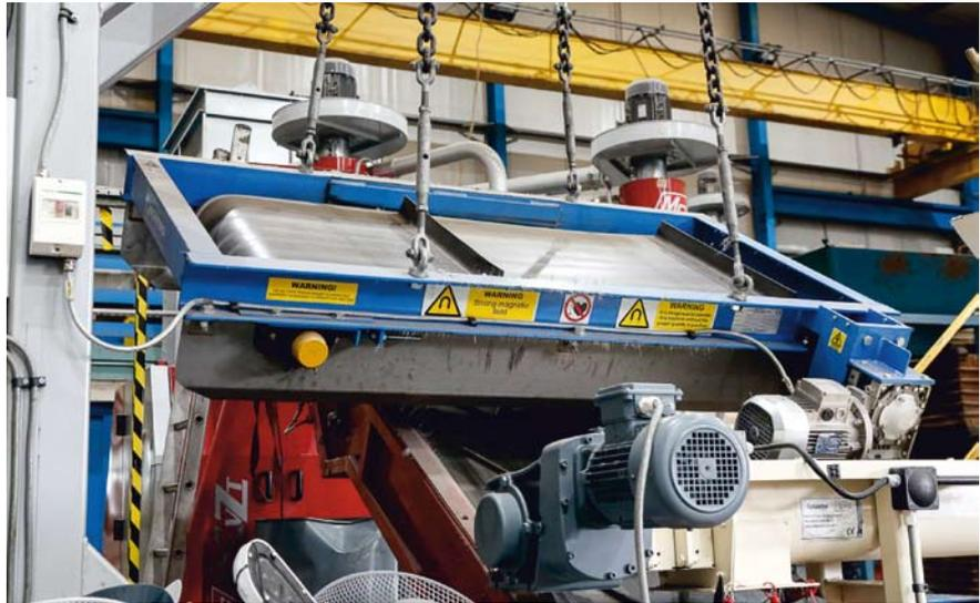
BC Single Pole, installiert in einem Elektroschrott-Recyclingbetrieb
