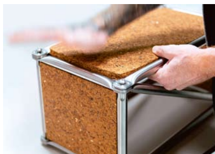
Fertigung und Montage von Bauteilen aus recycelten Werkstoffplatten zur Herstellung eines Demonstrators
