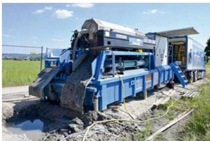
Das zu entsorgende Spülmateriale sowie grobe Fels- und Gesteinsreste werden in Gruben oder Containern gesammelt und dann abtransportiert
