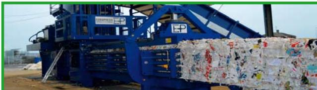
**Kanalballenpressen mit Draht- und Garnabbindung**
