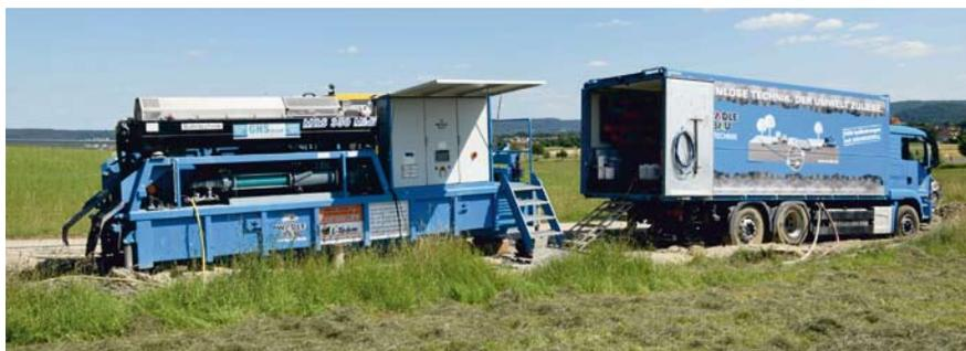
Das Modulare Recycling System MRS 350+ reinigt effektiv das mit Feststoffen versetzte Medium, wobei dieselbe Spülung beziehungsweise Suspension im Kreislauf eingesetzt werden kann
