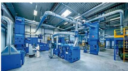
Anlagentechnik zum Carbonfaser-Recycling im Zentrum für Textilien Leichtbau am STFI
