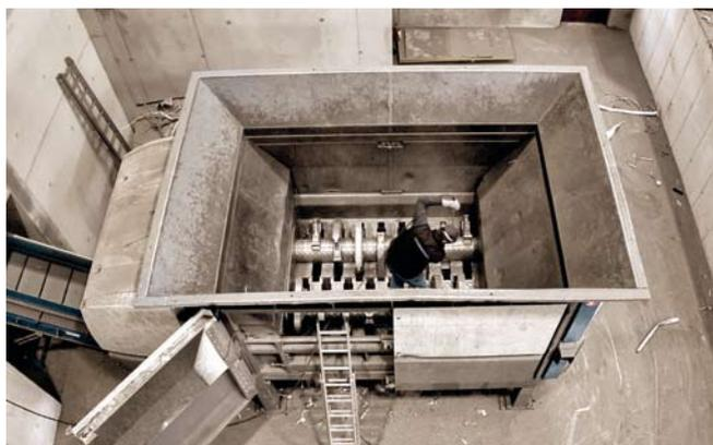
Blick in das Schneidwerk: Wartungsarbeiten
