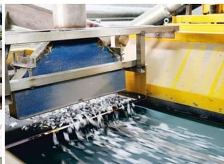
Schreddermaterial nach der mechanischen Zerkleinerung der Kühl-/Gefriergeräte
