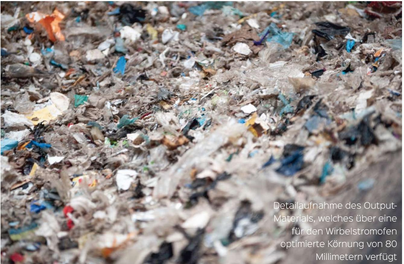
Detailaufnahme des Output-Materials, welches über eine für den Wirbelstromofen optimierte Körnung von 80 Millimetern verfügt
