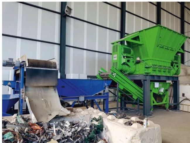
Im Modus A wird der Aluminiumschrott direkt in den Ripper RM1350 geleitet und anschließend mittels Hammermühle HA800 nachzerkleinert
