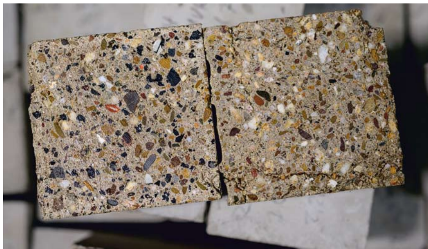
Probekörper mit MV-Asche (links im Bild) und Probekörper nach Standardrezeptur gefertigt
