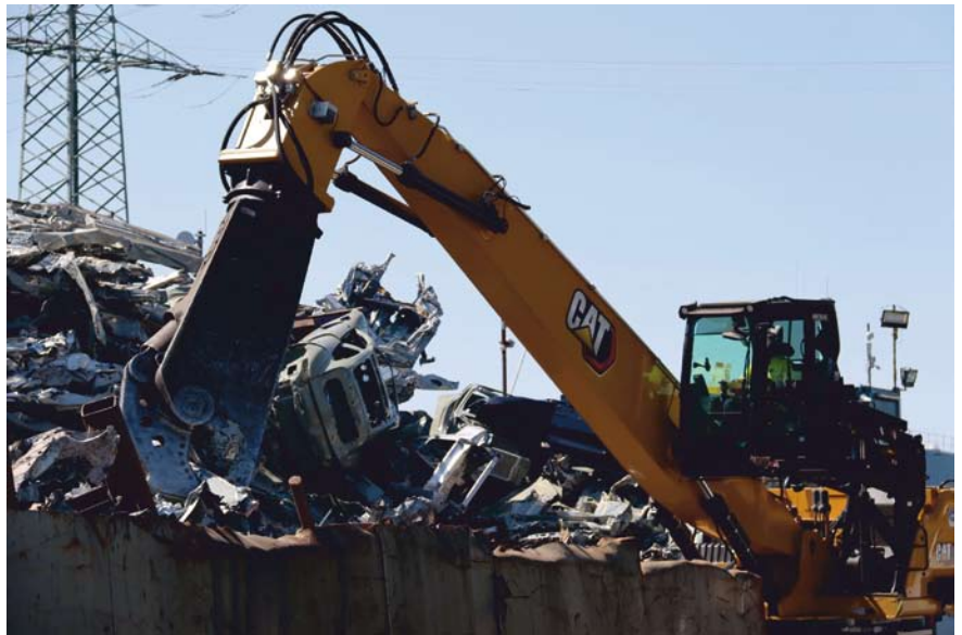
Der Direktanbau der Schere machte Anpassungen der Hydraulik erforderlich
