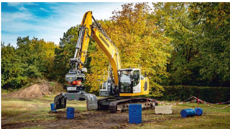
Autonomer Bagger beim Greifen von Fässern
