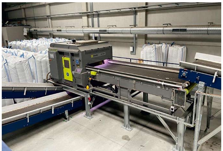
Multisensor-Sortiersystem Varisort+ zur Positiv-Erkennung von klarem PET in der Vor- und Nachsortierung
