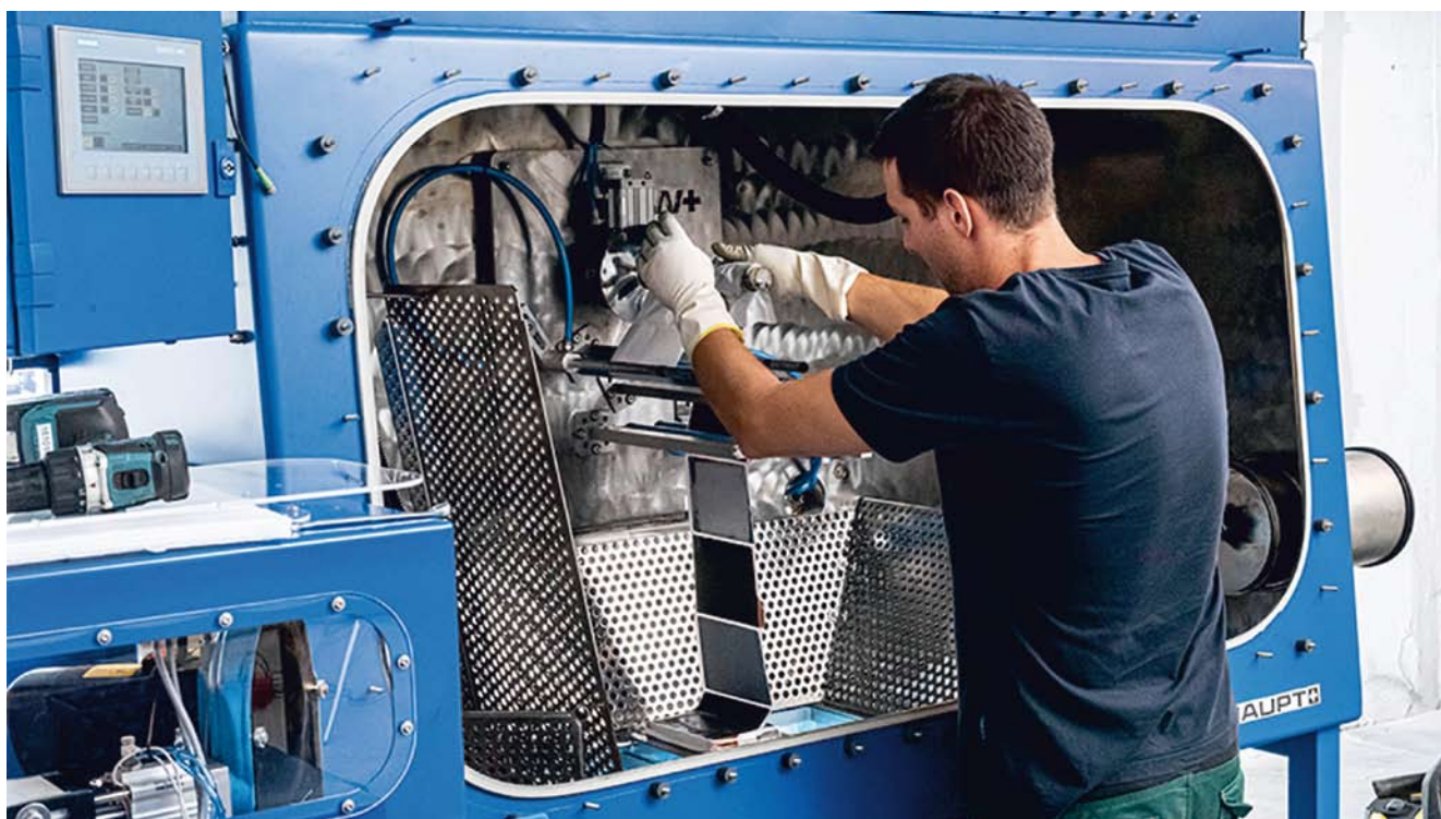
In der Pilotanlage werden ausgediente Batterien in ihre Einzelteile zerlegt
