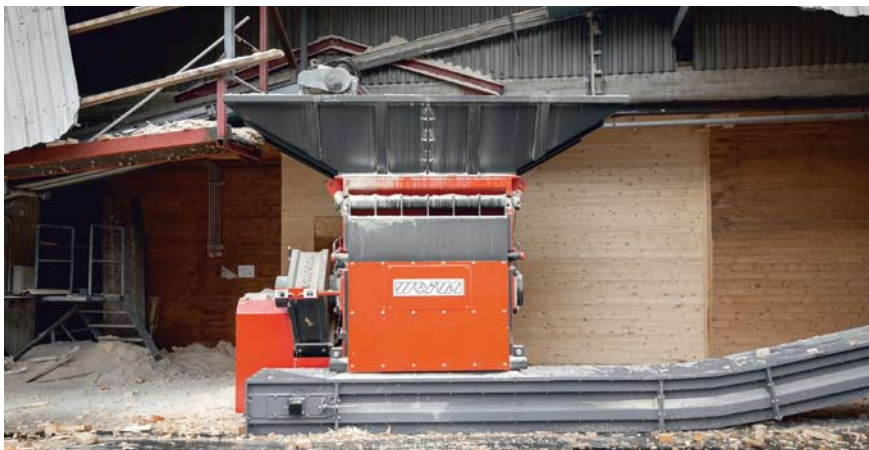
Weima S5.15 Einwellen-Zerkleinerer
