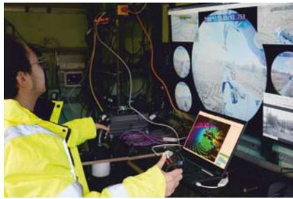
Vom mobilen Leitstand aus wird der Bagger „Arter“ des DFKI gesteuert
