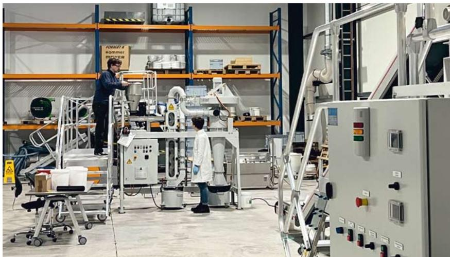
Mithilfe mechanischer Verfahrenstechniken wie dem Zick-Zack-Sichter werden die Materialien zerkleinert und sortiert
