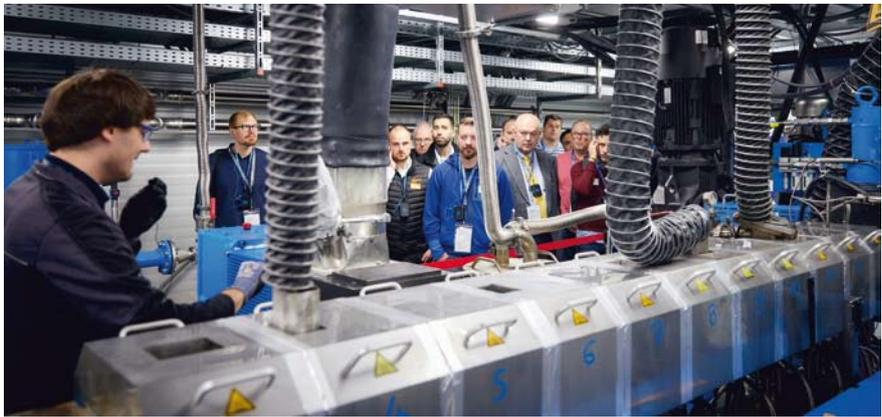
Die Vorführung rund um einem ZSK 58 Mc18 Extruder zeigte, wie rPE-Flakes zu rPE-Granulat verarbeitet werden
