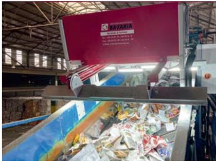
Die „MaxPosCam“ von Entsorgungstechnik Bavaria GmbH ermöglicht eine präzise und kontinuierliche Überwachung des Sortierprozesses für Deinking-Alt Papier in Echtzeit
