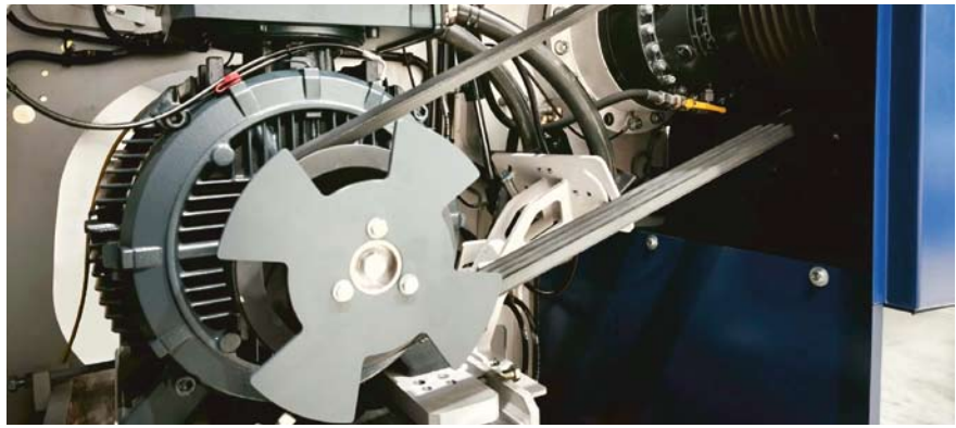
Synchron-Reluktanzmotor der Energieeffizienzklasse IE6 – das „Herzstück“ der Micromat-Serie IV
