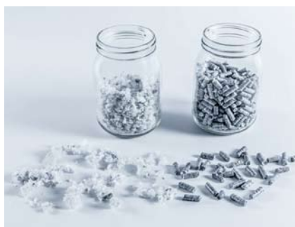
Vorher: Geschredderte Textilfasern; nachher: Rieselfähige Pellets
