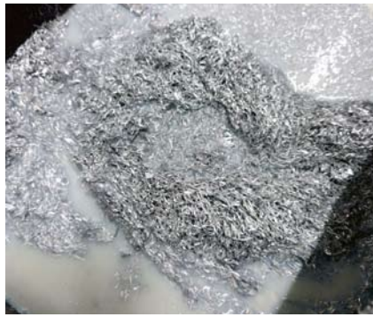
Nasse Späne: Unbehandelt verursachten sie hohen Handlingaufwand und Verschmutzungen
