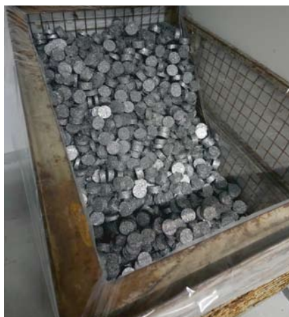
„Die Schüttdichte der Briketts ist 15- bis 18-mal so hoch wie die der Späne“
